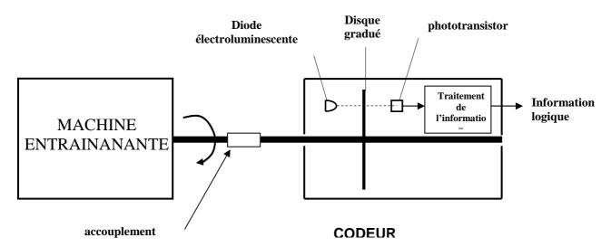
Un faisceau lumineux émis par des diodes électroluminescentes traverse les fentes du disque créant sur les phototransistors récepteurs un signal analogique.
